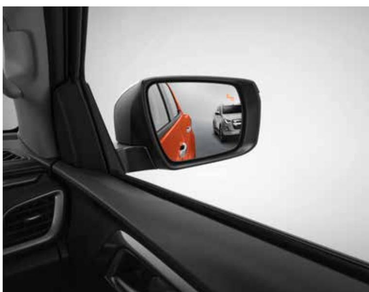
BSM – Blind Spot Monitor (détecteur d'angle mort)
